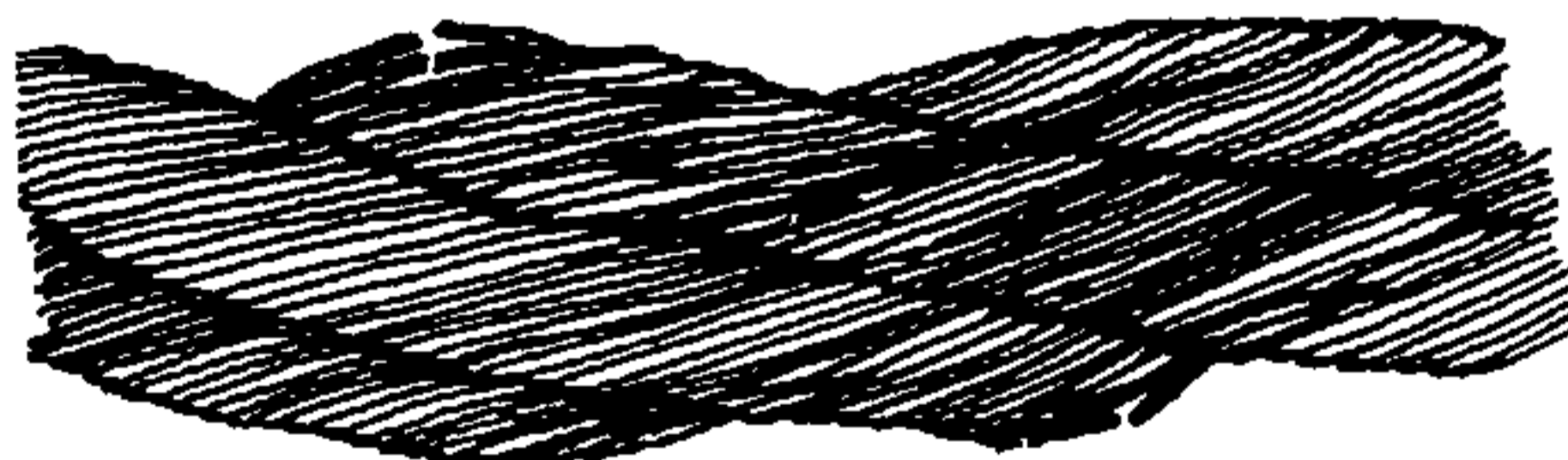
Рис. 1. Обрывы и смещения проволок каната крестовой свивки
