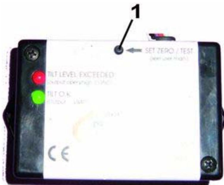
В режиме автотестирования моделируется наклон, превосходящий допустимый угол. Осуществляется внутренний контроль.
