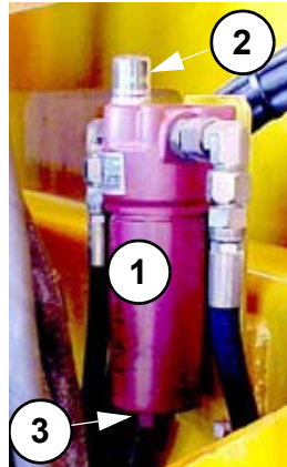
Фотография 16 - Гидравлический масляный фильтр контура перемещения
