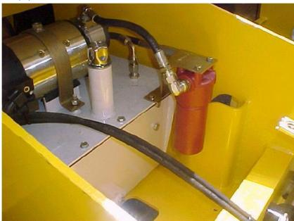
**5.3.1 – ФИЛЬТР ГИДРАВЛИЧЕСКОЙ ЖИДКОСТИ**
